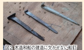
図2 木造和船の建造に欠かせない船釘
